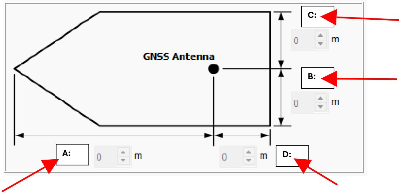
AIS'ens **GNSS / GPS** antenne posisjon i fartøyet (IKKE AIS'ens VHF antenne):
